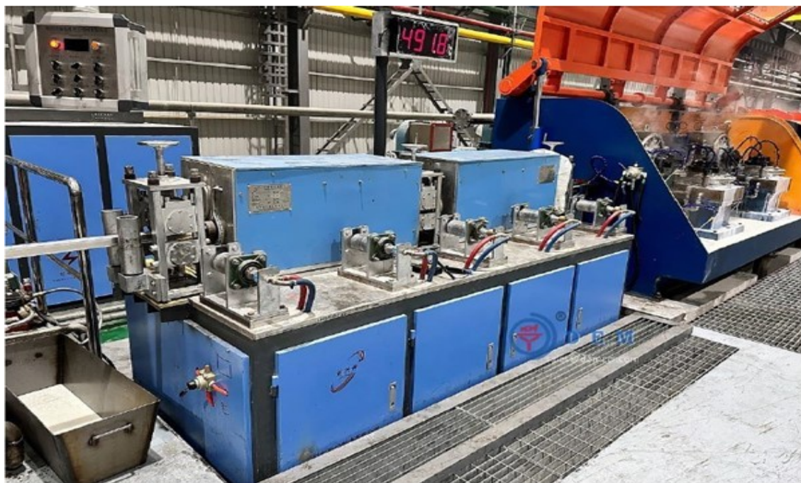
Slika br. 3.2.2-6: Izgled indukcionog grejača
