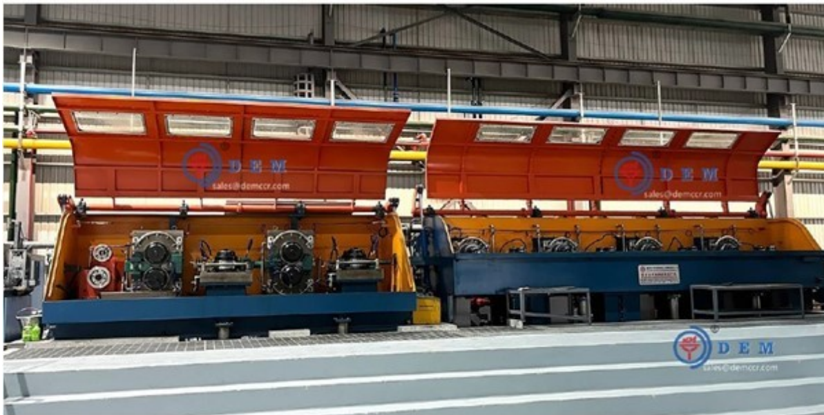
Slika br. 3.2.2-7: Prikaz mašine za grubo i finalno valjanje
