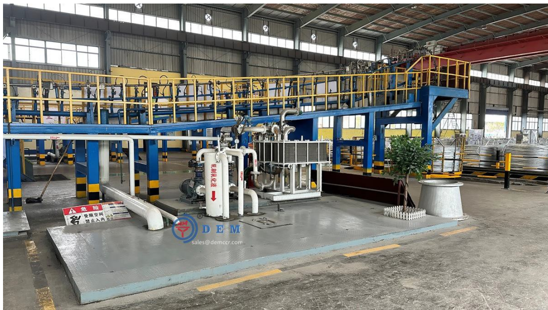
Slika br. 3.2.2-9: Sistem za kaljenje aluminijumske legure
